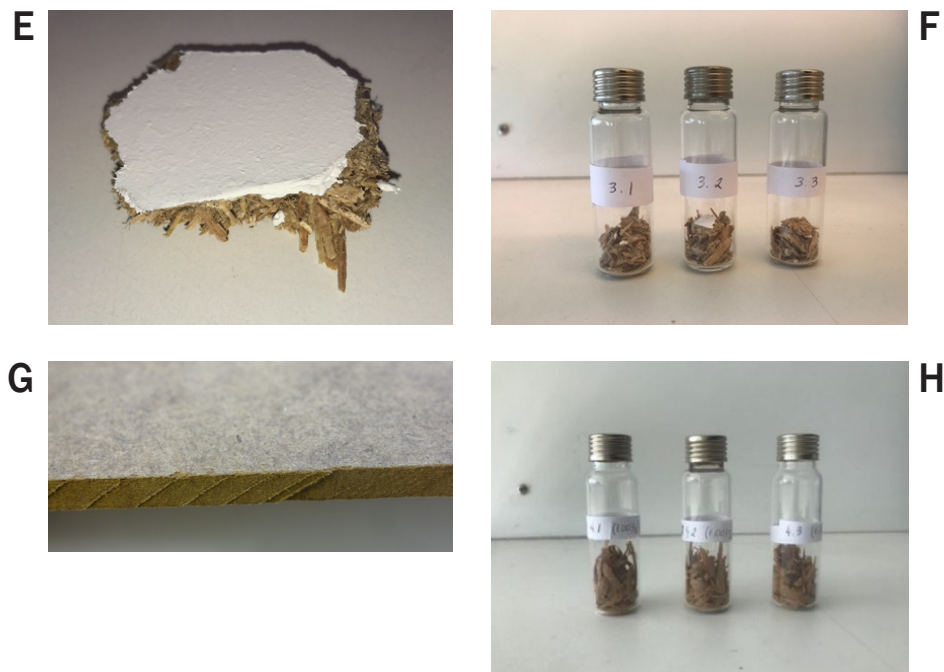
Figura 5. Amostras de materiais de construção de exposições temporárias antes e após serem pesadas e inseridas em vials . (A) Tinta plástica Robbialac Stucomat Ultra-mate branca; (B) Vials com tinta; (C) Aglomerado; (D) Vials com aglomerado; (E) Aglomerado pintado (revestimento aplicado há mais de 6 meses); (F) Vials com aglomerado pintado; (G) MDF; (H) Vials com MDF.
