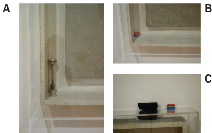
Figura 2. Posicionamento dos dispositivos de amostragem passiva na vitrine. (A): Dispositivo Tenax® TA; (B): Dispositivo para gases ácidos; (C): Data logger Testo e dispositivo para gases ácidos IVL posicionados sobre a vitrine.
